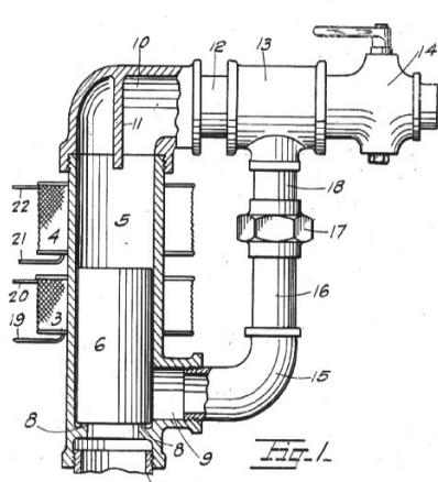
1930 Walker magnetischer Durchflusssensor für Wassererhitzer:
