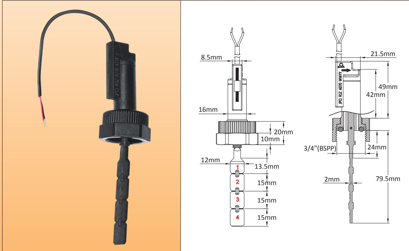
**Hauptanwendungen:** Sehr verbreitete Anwendungen bei der Durchflusserkennung mittels elektronischer Niederspannungsschaltungen. Die wirtschaftlichste Form. Empfohlene Montage-Position ist auf horizontalen Rohren. Kann in jeder Position mit geringer Abweichung in der Kalibrierung wegen des Paddelgewichts montiert werden. Kann an Wasserrohren mit  $\varnothing 15 - 100\text{mm}$  verwendet werden.
