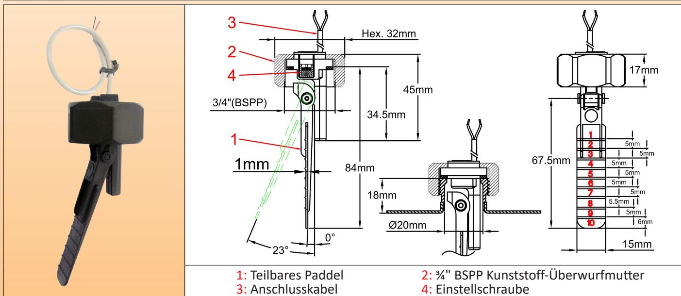
**Hauptanwendungen:** Der einfachste Durchflussschalter mit magnetischem Rückzug. Empfohlene Montage-Position ist auf horizontalen Rohren, kann aber in jeder Lage montiert werden. Zur Erkennung des Wasserdurchflusses in Wasserrohren mit  $\varnothing 25 - 100\text{mm}$ .
