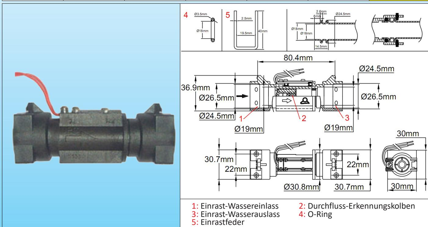
**Hauptanwendungen:** Das Produkt wurde für elektrische oder gasbetriebene Durchlauferhitzer entwickelt. Einrast-Wassereinlass und -Wassereinlass für Kupferrohre. Vertikale Montage vorgeschrieben, mit Wassereinlass von unten.
