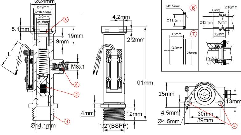
1:  $\frac{1}{2}$ " BSPP-Wassereinlass   2: Kolben zur Flusserkennung
